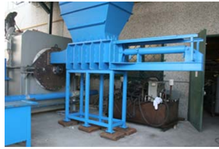
alimentatore rifiuti compattati alla bocca del pirolizzatore
